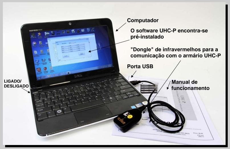
O computador eo dongle IR são especialmente configurados para comunicação com o gabinete de UHC-P. Esses itens especialmente configurado só estão disponíveis a partir Frymaster. Operacionalmente, o software baseado em computador mini é idêntico ao de programas do Palm que foi usado 2006-2010.
